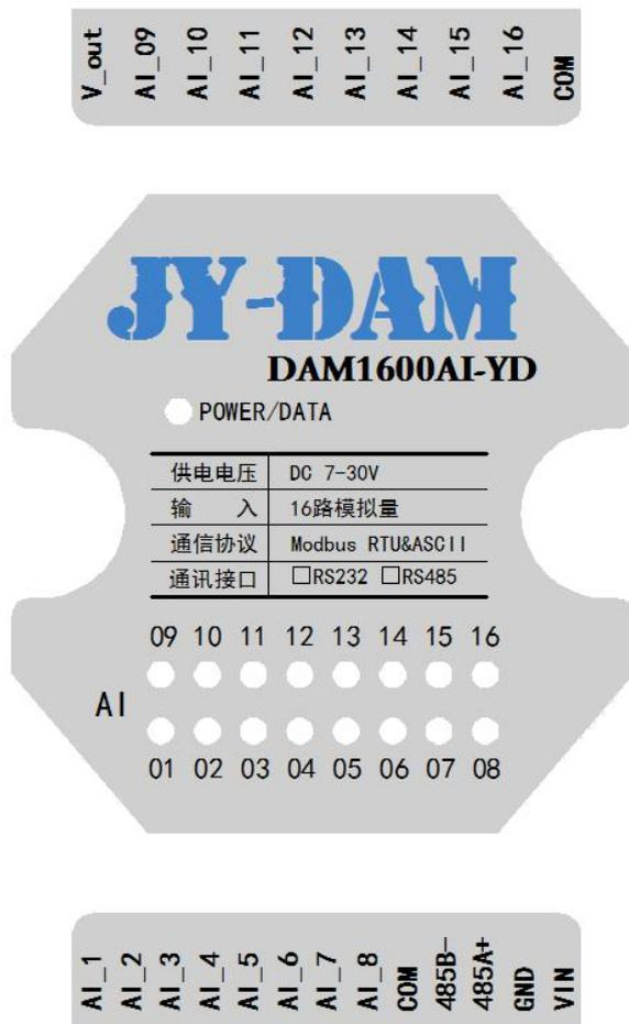
VIN 为供电电源正极，GND 为供电电源负极。
